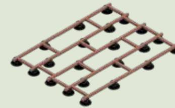
Bei der Montage mit Stelzlager haben Sie die Möglichkeit, Höhenunterschiede ohne Probleme auszugleichen. Die Stelzlager sind in verschiedenen Höhen erhältlich.
