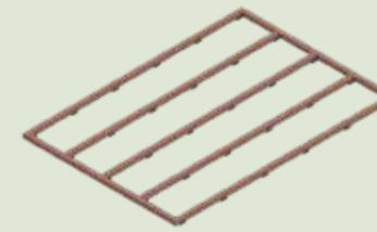
Die Bambus UK lässt sich auch ohne Stelzlager verwenden. In diesem Fall werden aMbooo® Gummipads als Unterlage verwendet, um die Lebensdauer der UK zu erhöhen.
